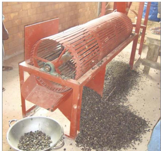
Mit dieser Maschine werden die Palmkern geschält.
